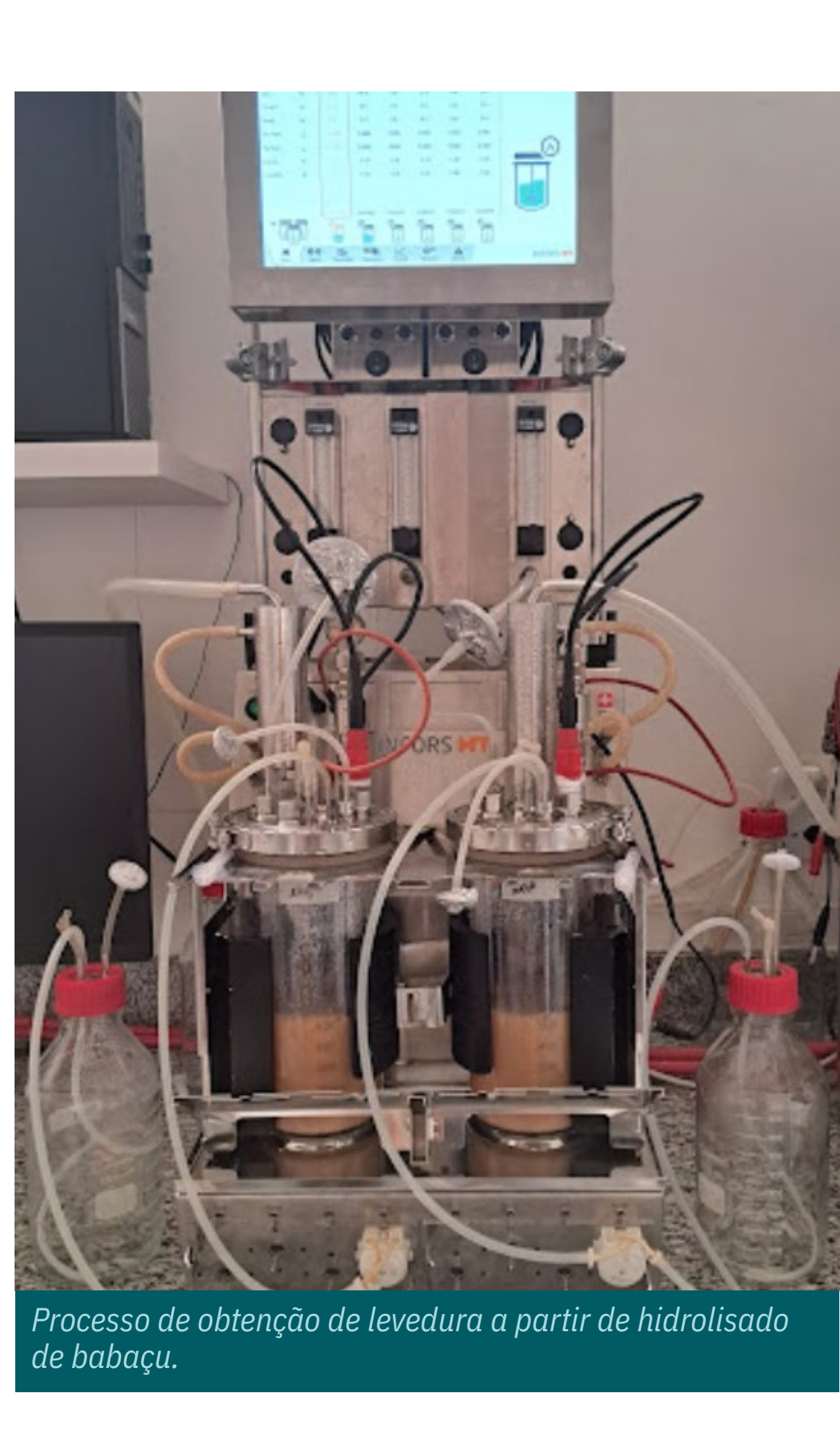
Processo de obtenção de levedura a partir de hidrolisado de babaçu.
